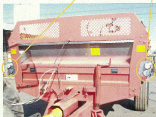
後部反射器及び灯火器類の設置例
