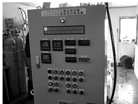
消化液よりアンモニア分離、アンモニアから水素回収装置
