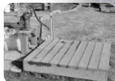
地下水をくみ上げるポンプ
