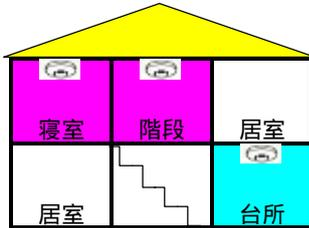
2階建住宅で、2階に寝室がある場合は、寝室と2階階段部分に設置して下さい。
