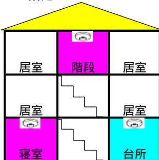
3階建住宅で、1階に寝室がある場合は、1階寝室及び3階階段部分に設置して下さい。
