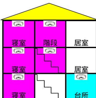
3階建住宅で、1階・2階・3階に寝室がある場合は、1階・2階・3階寝室及び2階・3階階段部分に設置して下さい。
