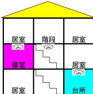
3階建住宅で、2階に寝室がある場合は、2階寝室及び2階階段部分に設置して下さい。
