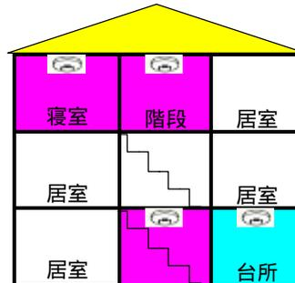
3階建住宅で、3階に寝室がある場合は、3階寝室及び1階・3階階段部分に設置して下さい。
