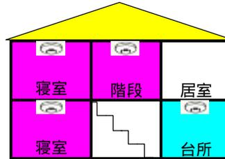
2階住宅で、寝室が1階、2階部分にある場合は、1階寝室・2階寝室及び2階階段部分に設置して下さい。
