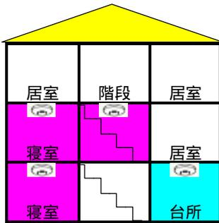
3階建住宅で、1階・2階に寝室がある場合は、1階・2階寝室及び2階階段部分に設置して下さい。
