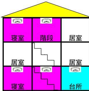
3階建住宅で、1階・3階に寝室がある場合は、1階・3階寝室及び1階・3階階段部分に設置して下さい。
