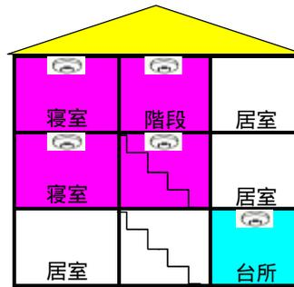
3階建住宅で、2階・3階に寝室がある場合は、2階・3階寝室及び2階・3階階段部分に設置して下さい。
